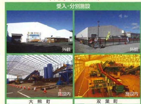
■除去土壌等を可燃物と不燃物、放射能濃度などによって分別しています。
