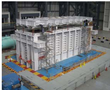
大型土槽による振動台実験
