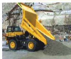
①ダンプトラック コンクリートを打設現場まで運搬します。
