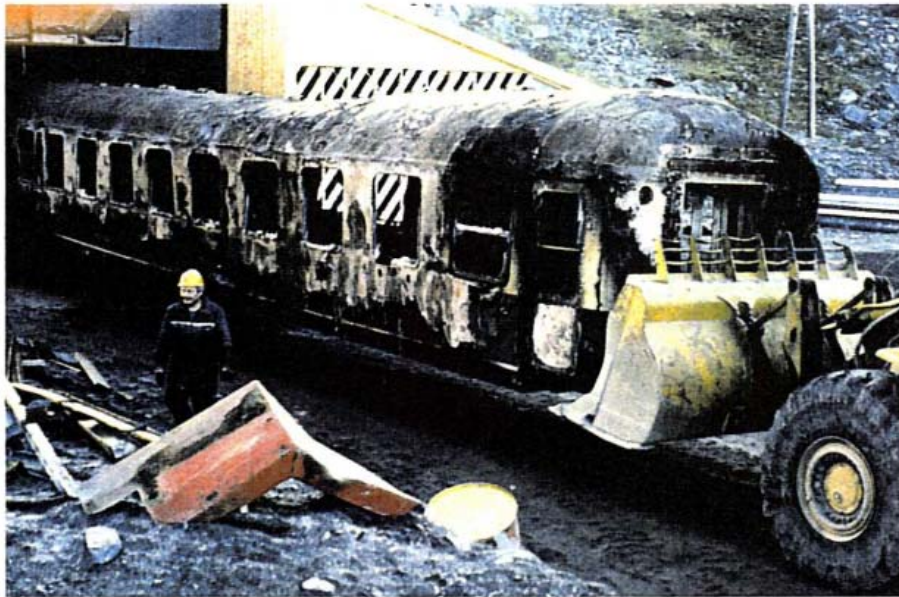
図14 火災実験後車両外観 6) (北陸トンネル火災車両に酷似)
