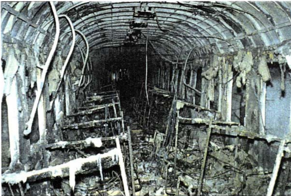
図13 火災実験後の車両内部 6)
