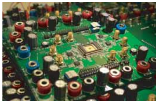
研究室で開発したADC回路のLSIチップと評価基板
