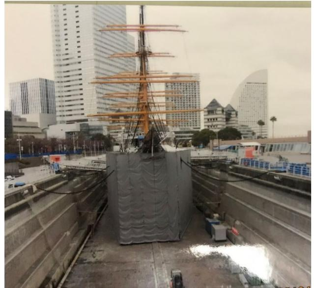
海水が抜かれた日本丸は、どの様にして背筋を伸ばして雄姿を見せているのでしょうか。ドッグ内の転倒防止策は、甲板のレベルから水平に設置された鋼材がドッグの壁面に固定され、あの大きな帆船が水平を保っていました。
